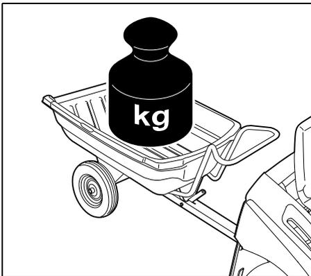
Poids maximal de remorque sur une surface plane = **250 kg**
